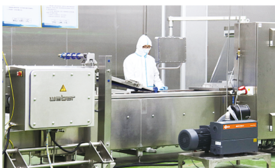
▼得利斯无菌车间，切片分份包装生产线。
