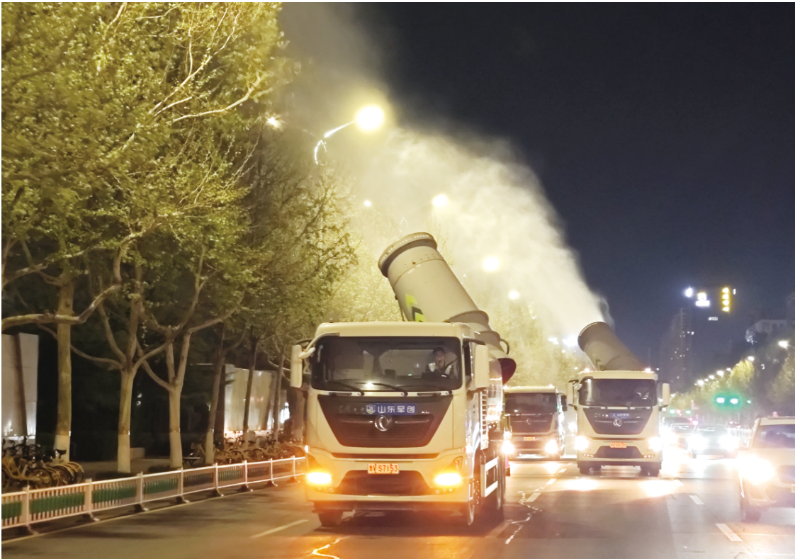
重型雾炮车正在作业。
