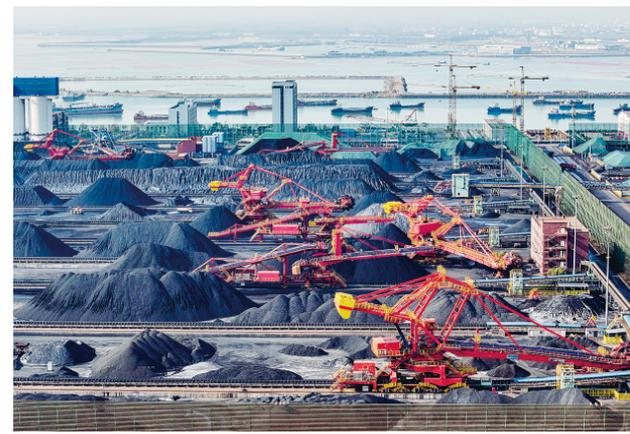
12月4日,在山东港口日照港大宗干散货智慧绿色示范作业区,堆取料机在翻堆煤炭(无人机照片)。山东港口日照港是我国“西煤东运、北煤南运”的重要沿海港口。该港依托堆取料机、翻车机等自动化设备,不断提升煤炭运输效率,优化和保障冬季煤炭供应。 新华社发
