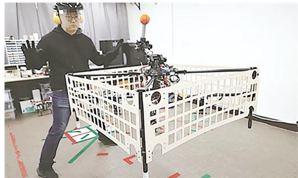
近日,以首尔科技大学为首的韩国研究组开发的“飞行购物车”(上图),其原理是将无人机装在购物车的底部,利用无人机的动力将购物车高度提升到胸部,消费者就可以自如地推动它至任何地方。研究人员又称“飞行购物车”为“托盘无人机”。
