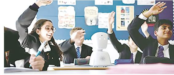
挪威“不孤立”科技公司日前研发了一款名为AV1的机器人(上图)。这款机器人搭配了可旋转摄像头以及麦克风,因病或者其他原因缺席的学生可以控制机器人,用其代替自己的眼睛和耳朵进行远程上课,用“举手”功能,让学生能在课堂回答提问。此外,学生还可以用机器人的面部显示不同的表情符号表达自己的情绪。
