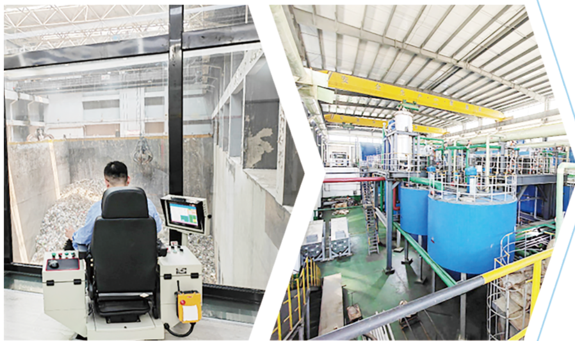
工作人员操作爪机对生活垃圾进行发酵处理。
