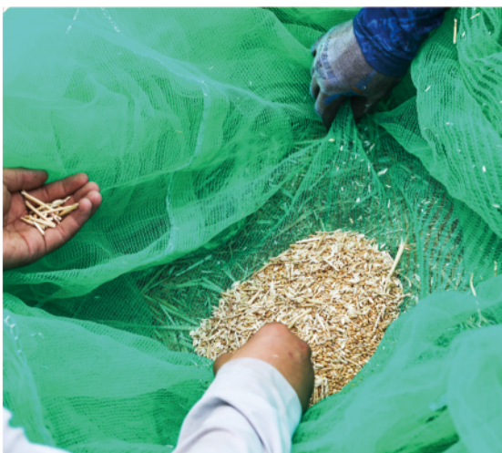
吹走麦糠，剩下的就是小麦，剩下的小麦越少，说明机器性能越好。
