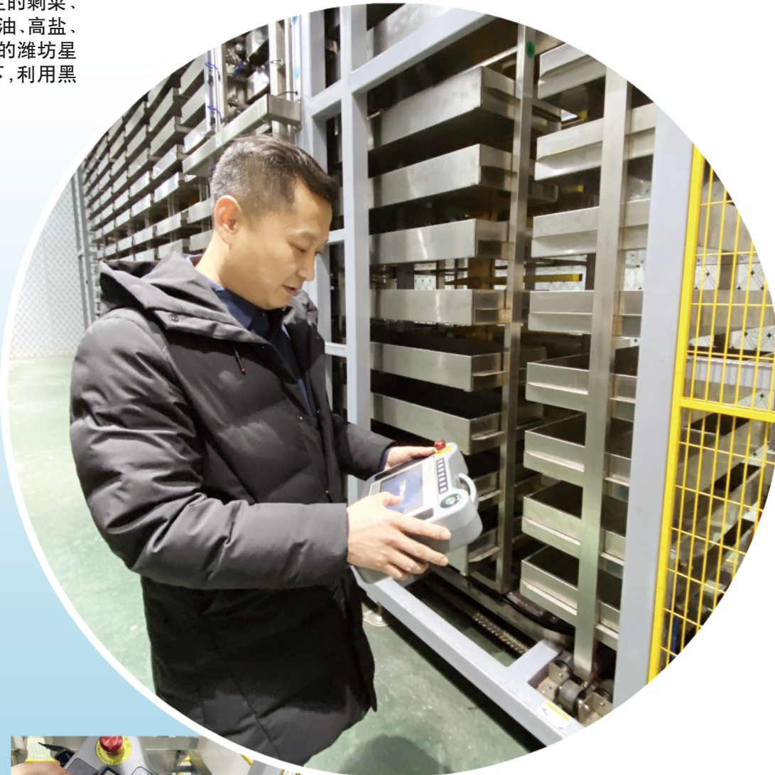
马贤杰在演示餐厨垃圾生物转化自动化设备循环系统。
