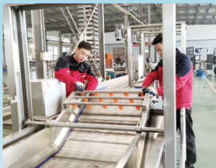
公司员工组装自动化循环转化系统生产线。
