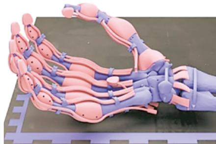
功地一次性打印出由不同弹性的聚合物制成的有骨骼、韧带和肌腱的机器人手。
