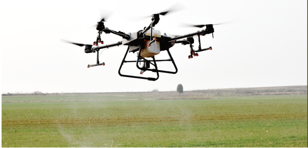
无人机正在对麦田进行施肥作业。
