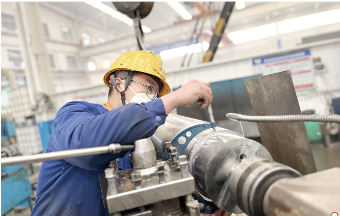
孙颜涛在用加长加重型车床加工磁选机的主轴。
